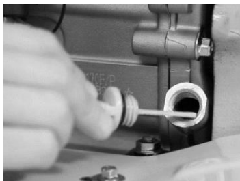
Fig. 5 – Verificarea nivelului de ulei la motor
